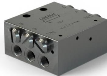
Schmierstoffverteiler der Baureihe SSVC sind kompakte Progressivverteiler in Blockbauweise. Für die Direktmontage von Verschraubungen ohne zusätzliche Dichtungen. Mit Anzeigestift für die visuelle Systemüberwachung oder Kolbendetektoren zur elektrischen Überwachung Der Verteiler setzt sich aus mehreren separat zu bestellenden Komponenten zusammen, siehe Tabelle.
