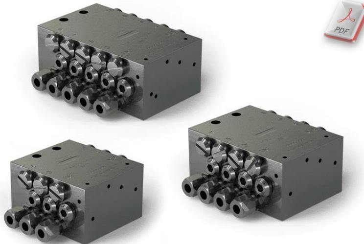
Verteiler vom Typ SSVD sind kompakte Progressivverteiler mit Blockbauweise, bei denen sich die Dosiermenge mithilfe verschieden großer Dosierschrauben einstellen lässt. Durch die Schraube wird jeweils die Dosiermenge eines gegenüberliegenden Auslasspaares dosiert. Auslassarmaturen lassen sich direkt, ohne zusätzliche Dichtung anbringen. Dieser vielseitige Verteilertyp ist in vielen verschiedenen Ausführungen hinsichtlich Überwachungsart und Oberflächenbeschichtung erhältlich.
