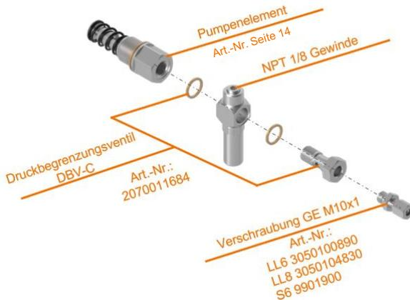
Abb. 16.2 Explosionszeichnung PE mit gerader Verschraubung
