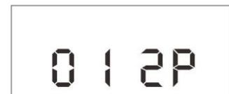
Abb. 23.5 Einstellung 2P Verteilerüberwachung Zyklen
