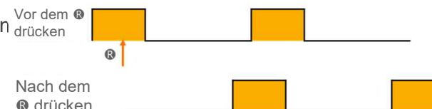
Abb. 24.5 Schmierzeit ändert sich durch drücken der Ⓡ Taste während der Schmierzeit
