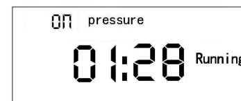
Abb. 24.3 Display für Schmierzeit 3P zählt aufwärts
