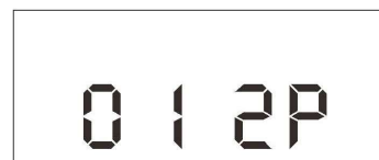
Abb. 23.5 Einstellung 2P Verteilerüberwachung Zyklen
